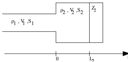
1°) Donner l'expression des coefficients de réflexion ( $r$ ), et de transmission ( $t$ ) en pression au passage d'un tuyau à l'autre.
