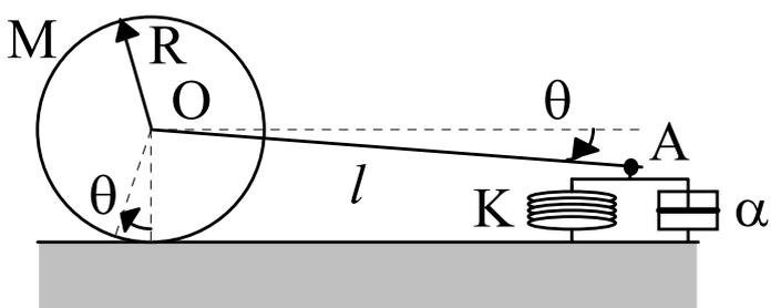
reliée au plan horizontal par l'intermédiaire d'un ressort de raideur  $K$  et d'un amortisseur de coefficient de frottement visqueux  $\alpha$ . A l'équilibre, la tige OA est horizontale. lorsque cette tige est écartée de cette position d'équilibre puis lâchée sans vitesse initiale, le système effectue des oscillations de petite amplitude faiblement amorties.
