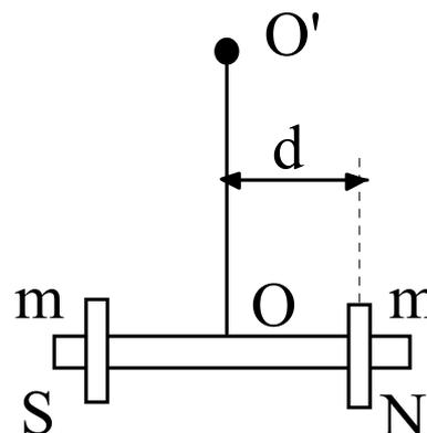
1) Sachant qu'aucun couple de torsion autre que magnétique n'agit sur le système, écrire l'équation du mouvement dans le cas où les frottements sont négligeables. En déduire la période d'oscillation du barreau dans le cas des faibles amplitudes. Retrouver l'équation du mouvement en utilisant la méthode de Lagrange.
