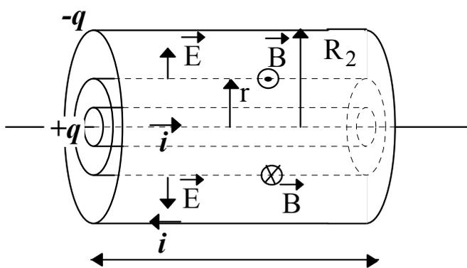
$$= \frac{q}{h2\pi\epsilon_0\epsilon_r} \ln \frac{R_2}{R_1}; \text{ la capacit  d'un  l ment de longueur } h \text{ est alors: } C = \frac{q}{\Delta V} = \frac{h2\pi\epsilon_0\epsilon_r}{\ln \frac{R_2}{R_1}} \text{ et la}$$
