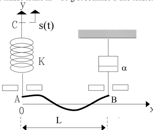
1/ Que représente l'amortisseur par rapport à la corde? Calculer l'impédance en un point quelconque de la corde. En déduire la tension  $T$  de la corde.
