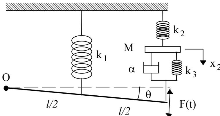
Par ailleurs, elle est soumise à une force  $F(t)$  perpendiculaire à la barre sinusoïdale, d'amplitude  $F_0$  et de pulsation  $\omega$ . En considérant les oscillations de faibles amplitudes et sachant qu'à l'équilibre la barre est horizontale:
