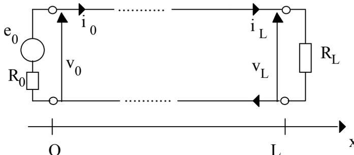
Calculer l'amplitude des différentes ondes  $v_1, v_2, \dots, v_i$  en  $x=L$  en fonction des coefficients de réflexion  $r_L, r_0$  en  $L$  et  $O$  et de  $\varphi$
