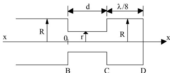
Calculer l'impédance acoustique du tuyau en  $x=0$ , puis trouver  $d$  en fonction de  $\lambda$  pour que cette impédance soit nulle. Quelle est, dans ces conditions, la valeur du coefficient de réflexion pour la pression en  $x = 0$  ?
