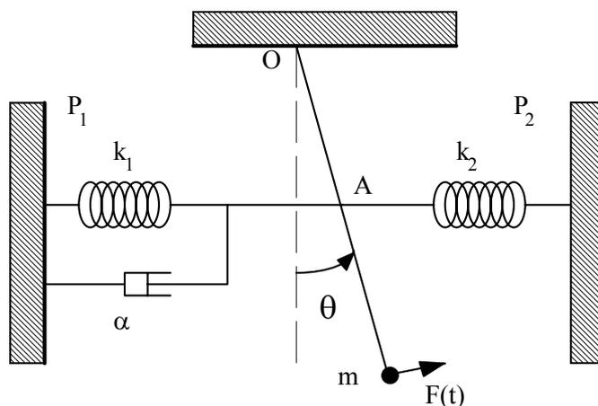
1. Déterminer l'expression de l'amplitude des oscillations en fonction de la pulsation  $\omega$ . En déduire la pulsation de résonance.
