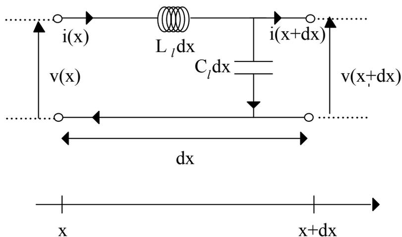
4/ Montrer, pour une onde sinusoïdale se propageant dans la direction des  $x$  croissants le long d'un câble infini, que l'impédance caractéristique vaut:  $R_C = \sqrt{\frac{L_l}{C_l}}$ . La calculer pour
