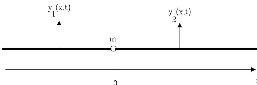
Une onde incidente de déplacement  $y_1(x,t)$  de pulsation  $\omega$  et d'amplitude  $a_0$  arrive de  $-\infty$  et se propage dans le sens des  $x$  croissants.
