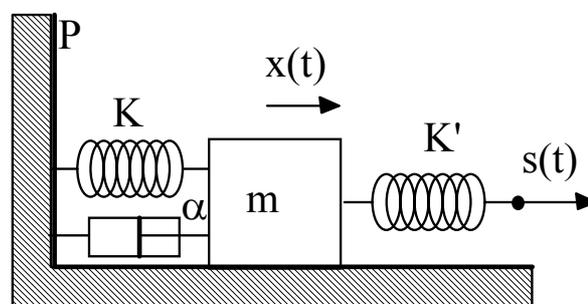
1/ Déterminer l'équation différentielle du mouvement de la masse  $m$ . En déduire la pulsation propre  $\omega_0$  et la force excitatrice agissant sur  $m$ .
