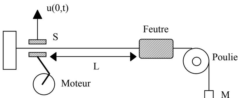
1/ La longueur totale de la corde est  $L=5\text{ m}$  et sa masse est  $m=100\text{ g}$ . Sachant que la vitesse de propagation des ondes transversales dans une corde de masse linéique  $\mu$  et tendue par une
