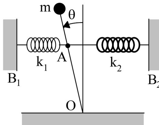
a) Sachant qu'à l'équilibre, les ressorts ne sont pas déformés, établir l'équation différentielle du mouvement du système.
