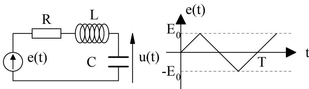
Le circuit RLC ci-dessus est alimenté par un générateur délivrant une force électromotrice périodique  $e(t)$  telle que représentée sur le schéma.
