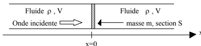
1°) Donner l'expression de la pression  $p_1(x,t)$  pour la partie des  $x<0$  et  $p_2(x,t)$  pour la partie des  $x>0$ , en fonction des données du problème et des coefficients  $r$  et  $t$  qui représentent respectivement le coefficient de réflexion et de transmission pour la pression au point  $x=0$ . En déduire l'expression de la vitesse de particules  $\dot{u}_1(x,t)$  et  $\dot{u}_2(x,t)$  pour chacune des deux régions  $x<0$  et  $x>0$ .
