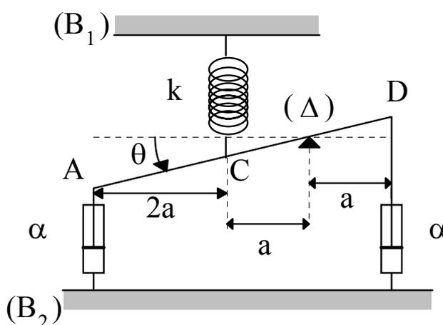
Lorsque la tige est écartée de sa position d'équilibre d'un angle  $\theta_0$  puis lâchée sans vitesse initiale, elle prend un mouvement oscillatoire amorti de pseudo-période  $1\text{s}$ . On constate qu'au bout de 5 pseudo-périodes, l'amplitude est égale à 20 % de l'amplitude initiale. En déduire la valeur numérique de  $\alpha$  puis celle de  $k$ .
