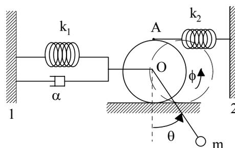
Ce système constitue un système à deux degrés de liberté. On choisit les coordonnées  $\theta$  et  $\phi$  pour décrire ce système. A l'équilibre  $\theta = \phi = 0$ . Dans le cas des petites oscillations et pour  $k_1 + 4k_2 = k = mg/l$  et  $m = 3/2M$ .
