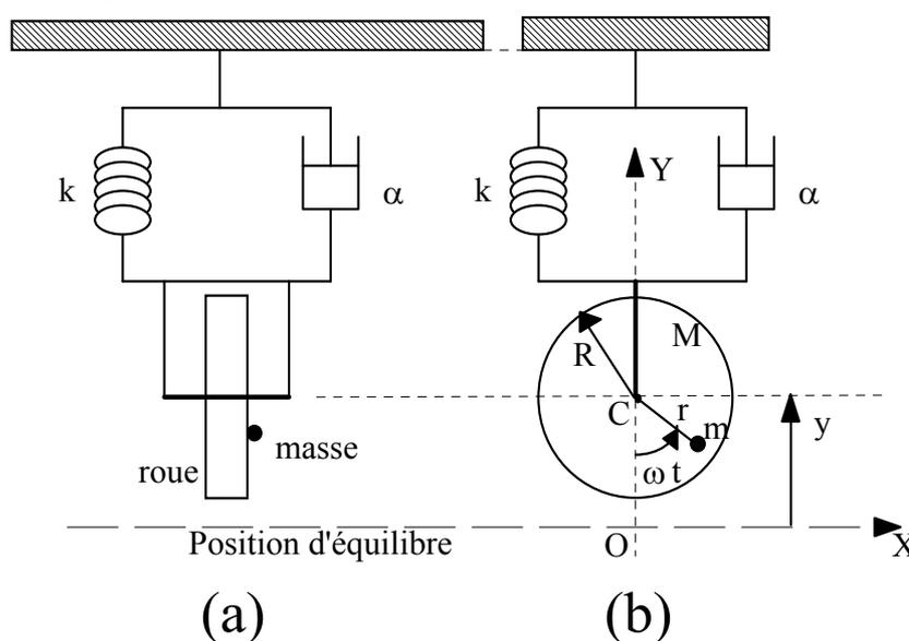
1. Quelles sont dans le repère  $XOY$ , les coordonnées de la masse  $m$  à l'instant  $t$ , lorsque le moteur tourne à une vitesse angulaire  $\omega$ .
