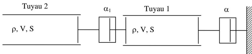
Une onde incidente se propage de la gauche vers la droite dans le tuyau 2, elle est transmise dans le tuyau 1 qui est alors parcouru uniquement par une onde progressive. Montrer que cette configuration est équivalente au tuyau 2 terminé à droite par un amortisseur dont le coefficient de frottement visqueux est  $\alpha_T = \frac{\beta\alpha}{\beta + \alpha}$ . Donner l'expression de  $\beta$  en fonction de
