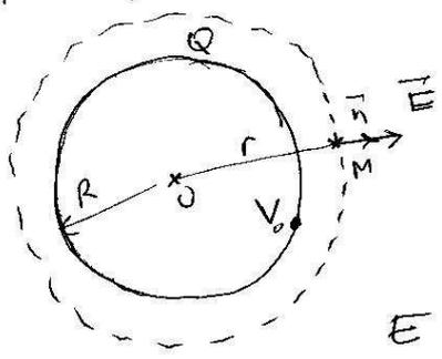
∮<sub>S<sub>r</sub></sub> E · n̄ dσ<sub>r</sub> = 1/ε<sub>0</sub> Σ q<sub>i</sub>
