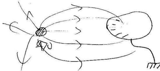
le sol et le conducteur forment alors un conducteur 46 unique et les charges positives qui devraient apparaître sur le conducteur A sont repoussées dans le sol et aucune ligne de champ ne quitte A.
