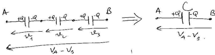
$$V_A - V_B = v_1 + v_2 + v_3$$
