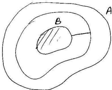
Le court-circuit de A et B fait passer la charge du conducteur B (potentiel variable de  $V_B$  à  $V_A$ ) au conducteur A.
